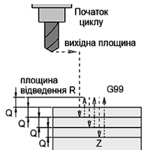
Рисунок 17.2. – Принцип роботи циклу переривчастого свердління.
