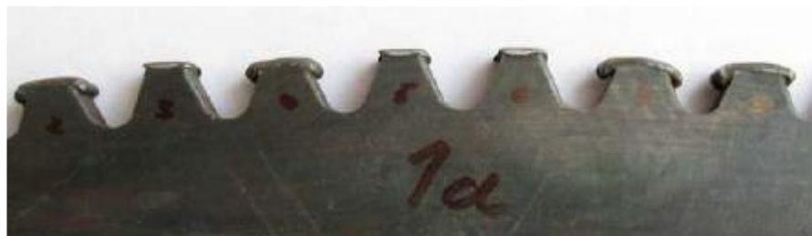
Рисунок 2.6 – Фотографія сектора традиційної пилки з характерним зносом зубів
