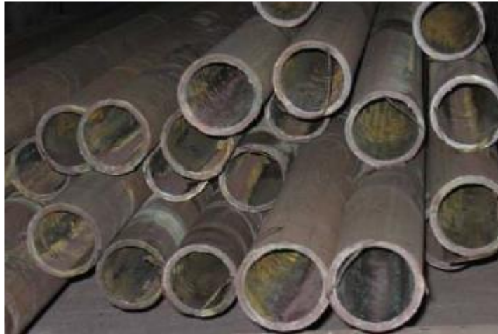
Рисунок 3.4 – Фотографія утвореного задирка при відрізку труби з нержавіючої сталі 12Х18Н10Т пилкою з новою геометрією
