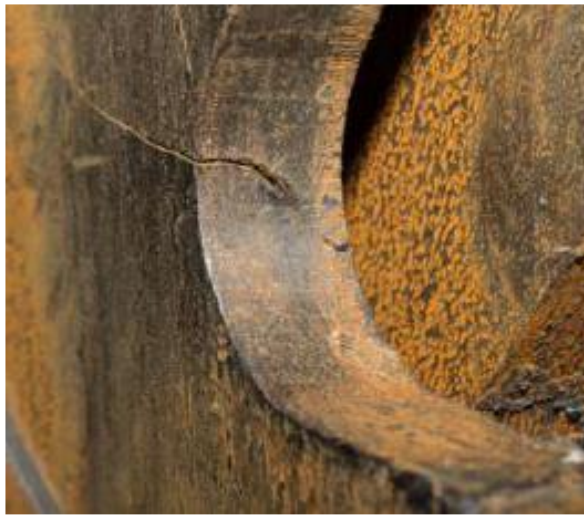
Рисунок 2.8 – Зовнішній вигляд западини зуба пили з тріщиною
