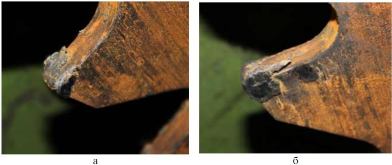
Рисунок 2.9 – Зовнішній вигляд модифікованого шару контакту на вершині зуба:
