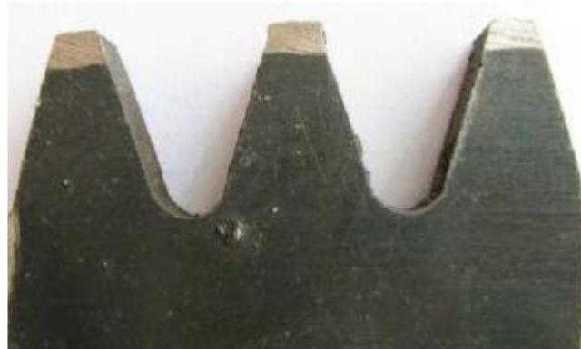
Рисунок 2.4 – Фотографія сектора традиційної пилки з високим зубом
