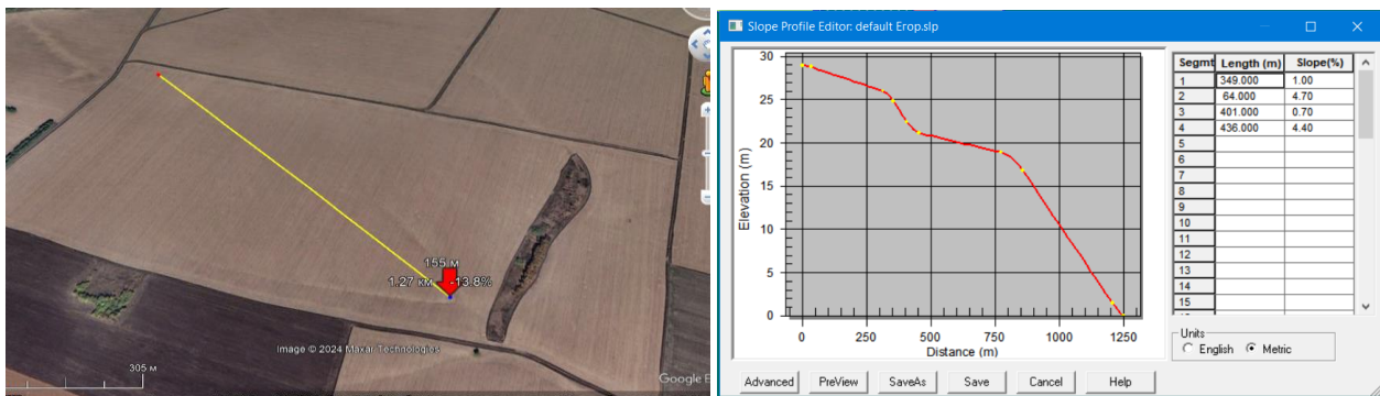
Рис. 3.2 - Схематичне поділення схилу на відрізки залежно від кута нахилу для моделювання водної ерозії (Схил 1)
