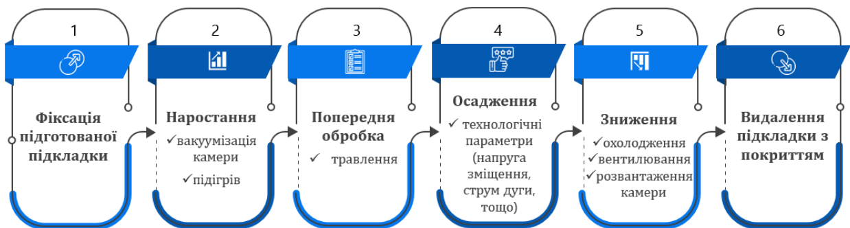
Рис 2.4. Технологічні операції виконані при нанесенні покриттів іонно-плазмовою технологією.
