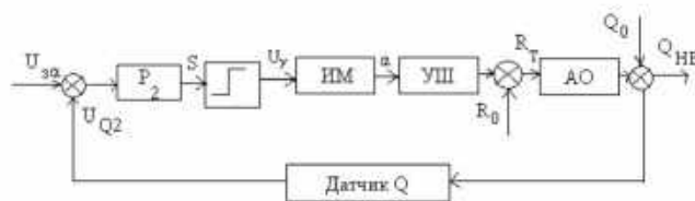
Рисунок 6.5 – Функціональна схема САУ УШ
