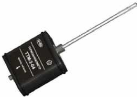
Рисунок 5.7 - Перетворювач швидкості повітряного потоку ТТМ-2-04-02
