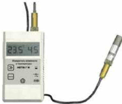
Рисунок 5.8 - Термогігрометри серії IBTM-7
