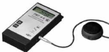
Рисунок 5.10 - Газоаналізатор серії ПКГ-4
