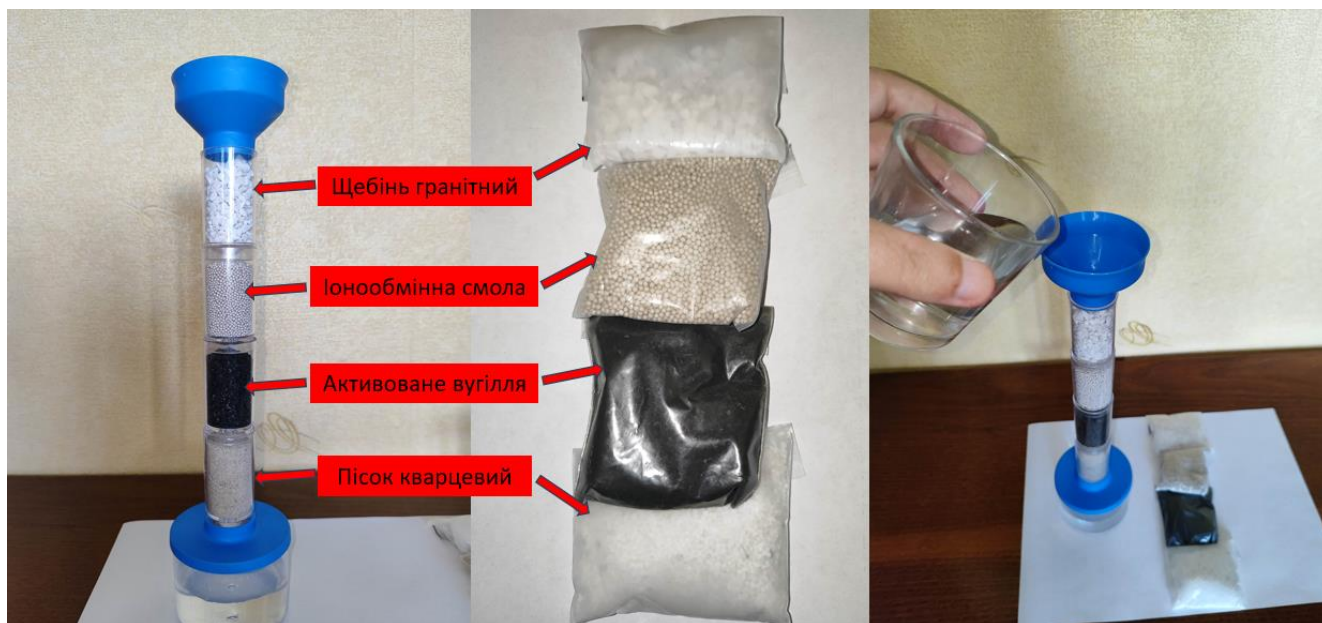
Рис. 3.12 Фільтрування води через колонку з іонообмінними смолами та активованим вугіллям в домашніх умовах
