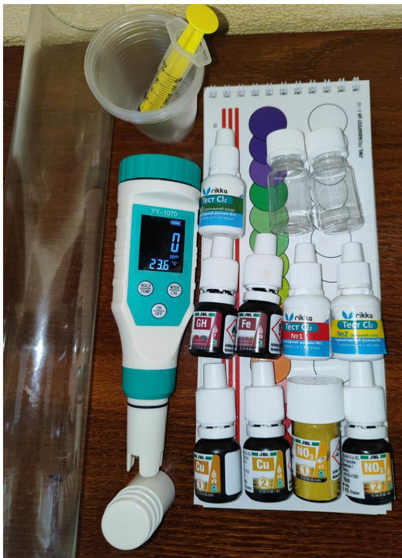
Рис. 2.2 Перелік лабораторного обладнання, застосованого для визначення фізико-хімічних та санітарно-токсикологічних параметрів у досліджуваних зразках води
