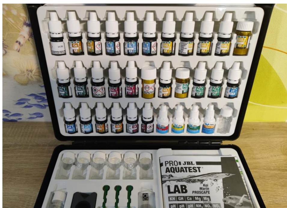
Рис. 2.3 Титрометричний комплект AQUATEST використовується для аналізу води з метою визначення жорсткості, вмісту хлоридів, заліза, міді та нітратів
