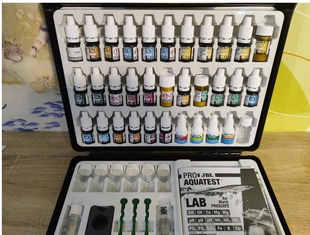
Рис. 2.3 Титриметричний набір, що призначений для визначення у воді хлору залишкового, загальної жорсткості та вмісту заліза
