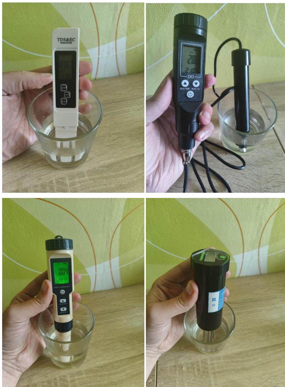
Рис. 2.2 Потенціометричні прилади, що використовувалися для вимірювання у воді рН, загальної мінералізації, засоленості, електропровідності та нітратів
