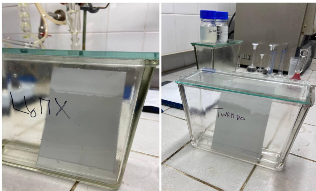
Рисунок 2.1. Хроматографічні камери з різними рухомими фазами:
