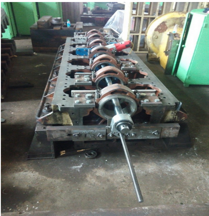
Рисунок 3.3 – Розточування одночасно 7 отворів верстатом ВВ5000
