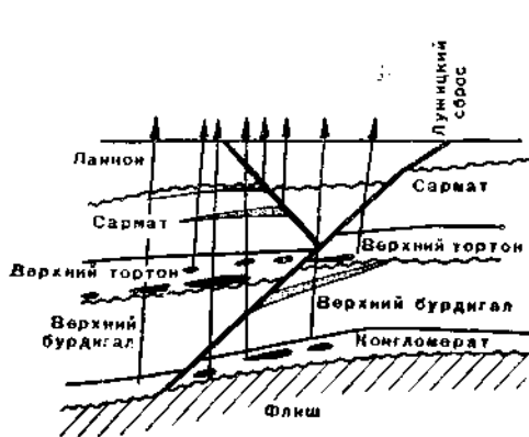
Рис. 26. Лужиці. Пластові літологічно екрановані поклади в розрізі (М. Длабач).
