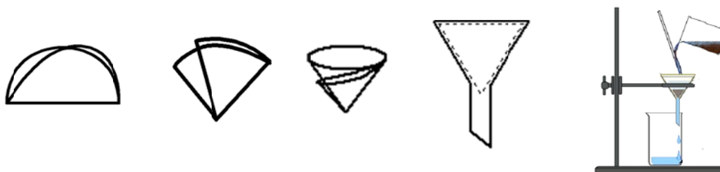
Рис. 9. Виготовлення фільтру та фільтрування
