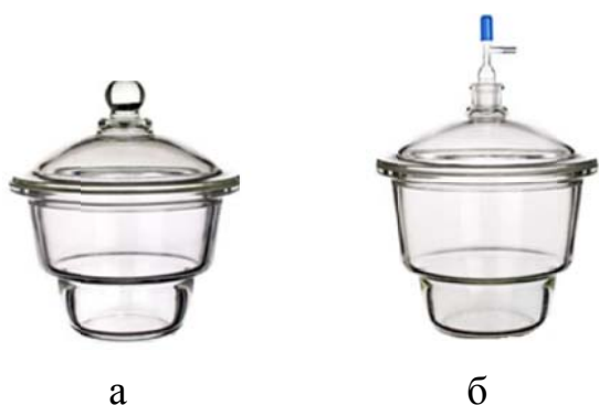
Рис. 14. Звичайний (без крана – а) і вакуумний (з краном – б) ексикатори
