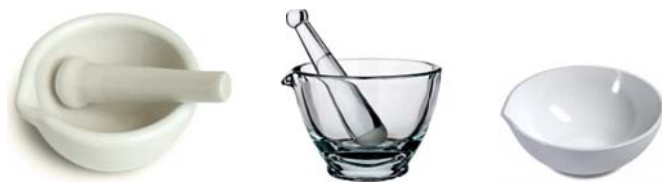
Рис. 13. Фарфорова і скляна ступки з товчачиками та випарювальна чашка
