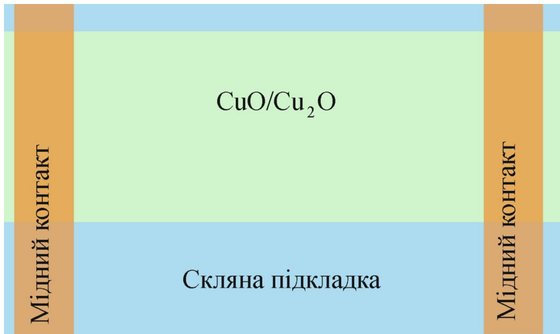
Рис. 1 Схема зразка для дослідження теплової чутливості шарів міді.
