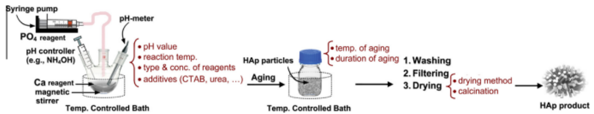
Рис. 2. Отримання наночастинок НАр методом звичайного хімічного осадження.
