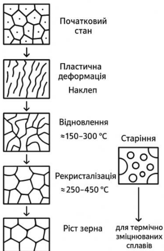
Рис. 1. Мікροструктурні перетворення під час термомеханічної обробки алюмінію
