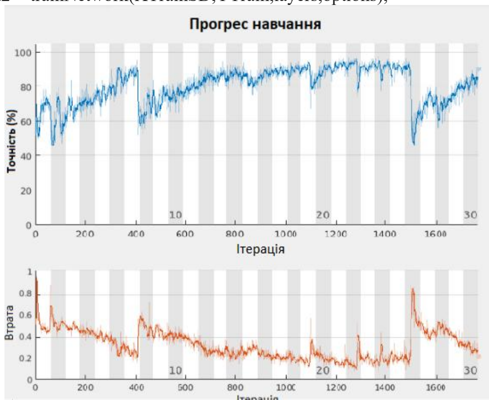
Рисунок 3.8 - Діаграми точності та втрати прогресу навчання LSTM-мережі з частотно-часовими характеристиками
