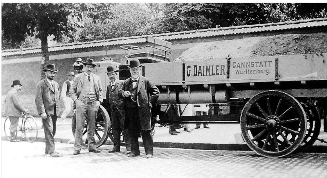
(слева направо) В.Лоренц, Б. Луцкий, В. Майбах, Г. Даймлер в июне 1898 года на Всемирной выставке в Париже около грузовика "Даймлер" грузоподъемностью 5 тонн с двухцилиндровым двигателем мощностью 10 л.с. Фото из архива "Даймлер-Бенц-Музеум"
