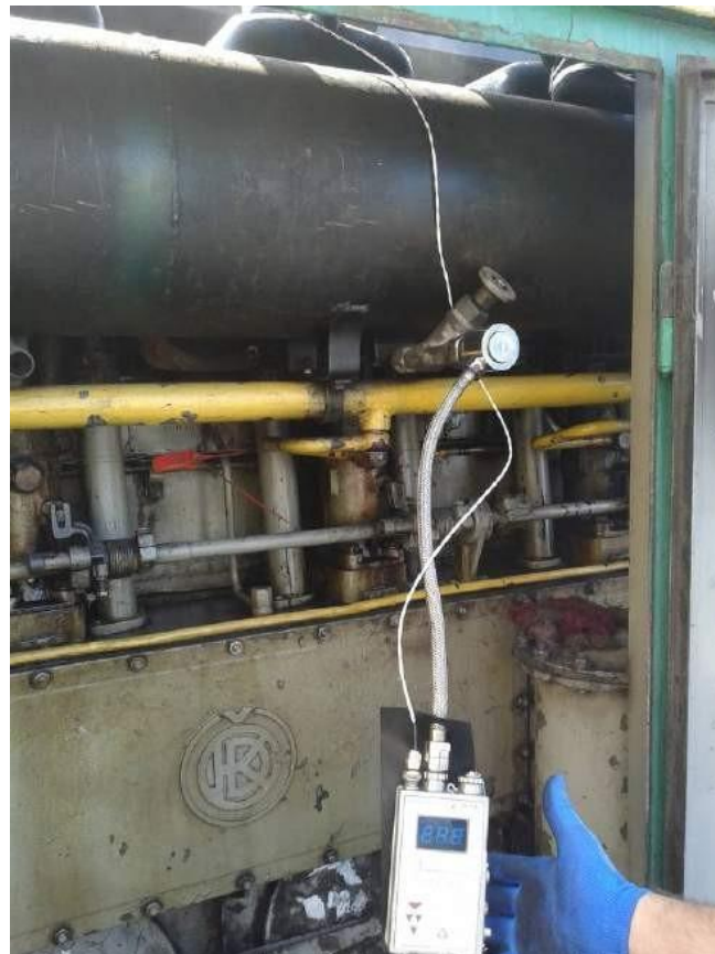
Рис. 1.4 – Розміщення датчика тиску Ps-30M на кран індикаторний
