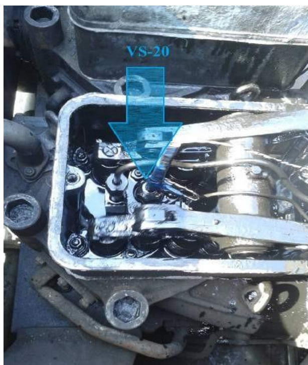
Рис. 1.3 – Розміщення віброакустичного датчика vs-30 на паливну форсунку ДВЗ
