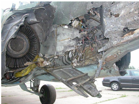
Рис. А.5 Пошкодження двигуна і конструкції літака у наслідок зіткнення з птахом
