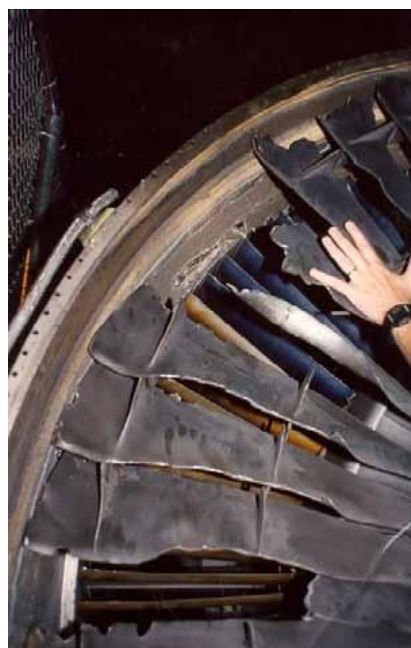
Рис. А.8 Обрив лопаток, деформації та викривлення у наслідок попадання птаха у двигун
