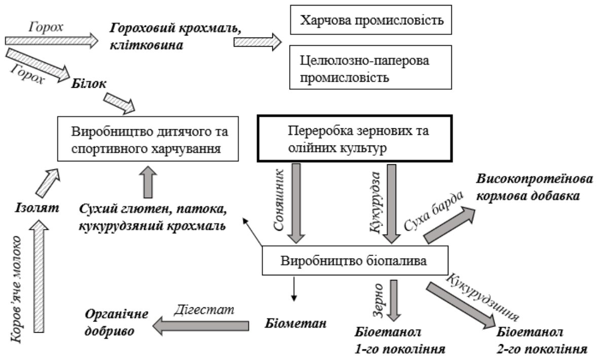
Рис. 2.10. Приклад схеми виробництва біопалива та вторинних продуктів з зернових та олійних культур (створено за: [14; 52-53]).
