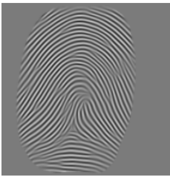
Рисунок 2.4 – Габор покращив зображення (після аналізу STFT).
