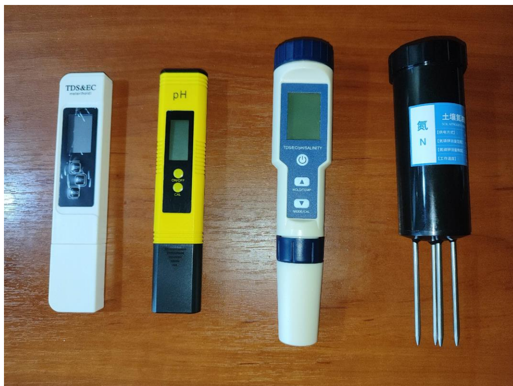
Рис. 2.2 Потенціометри для вимірювання рН, солей, загального вмісту солей, електропровідності та нітратів у воді.
