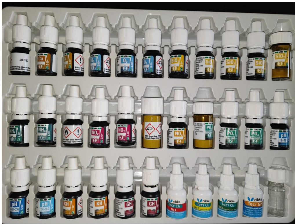
Рис. 2.3 Набори для титрування для визначення загальної жорсткості, залишкового хлору, заліза та міді у воді
