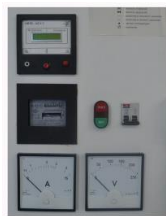
Рис. 10.10 – Блок керування й захисту стенда
