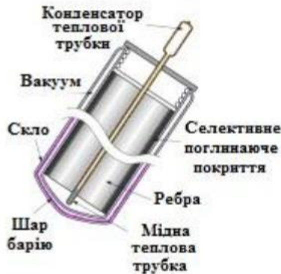
Рис. 6.2 – Будова сонячного колектора
