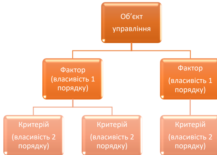
Рис. 3.2. Схема процесу декомпозиції властивостей об'єкта управління в рамках кваліметричного моделювання.
