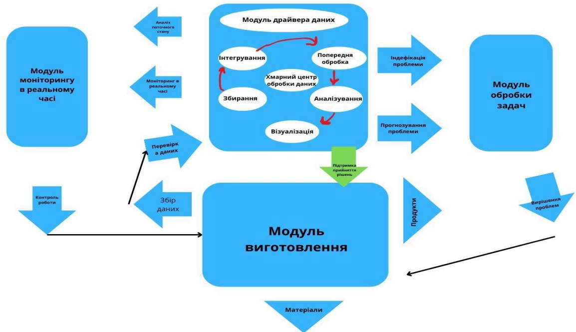
Рисунок 1.3 Структура для інтелектуального виробництва на основі даних
