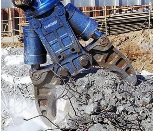
Рисунок 1.8 - Гідроножиці з двома гідроциліндрами.
