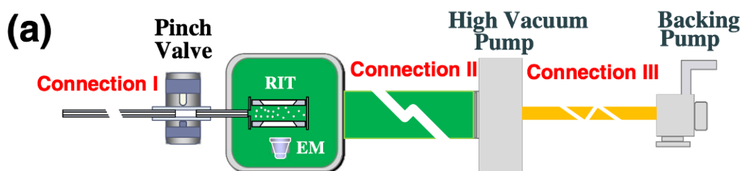
Рис. 2.7 Схематичне зображення, що ілюструє загальну конфігурацію вакуумної системи для мініатюрної іонної пастки DAPI [61]
