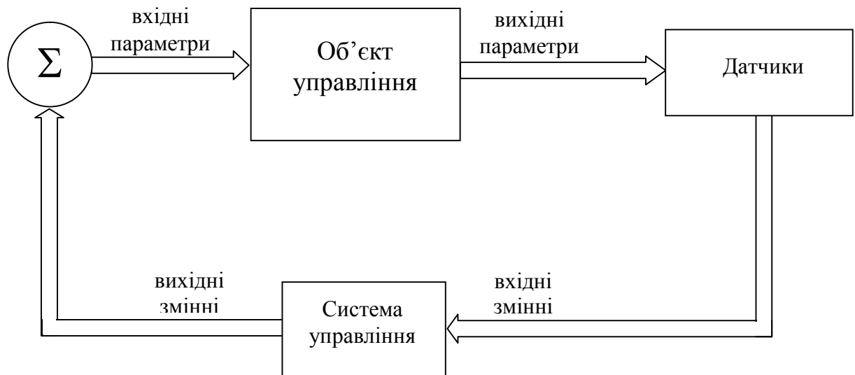
Рисунок 1.1 – Архітектура компонентів процесу управління із зворотним зв'язком
