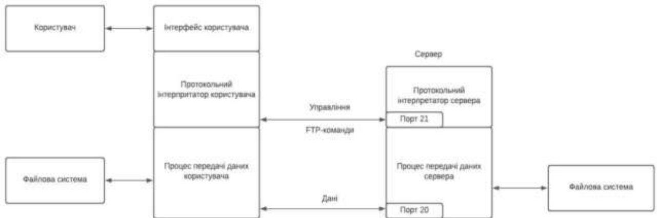
Рис. 2.1. Схема роботи протоколу FTP
