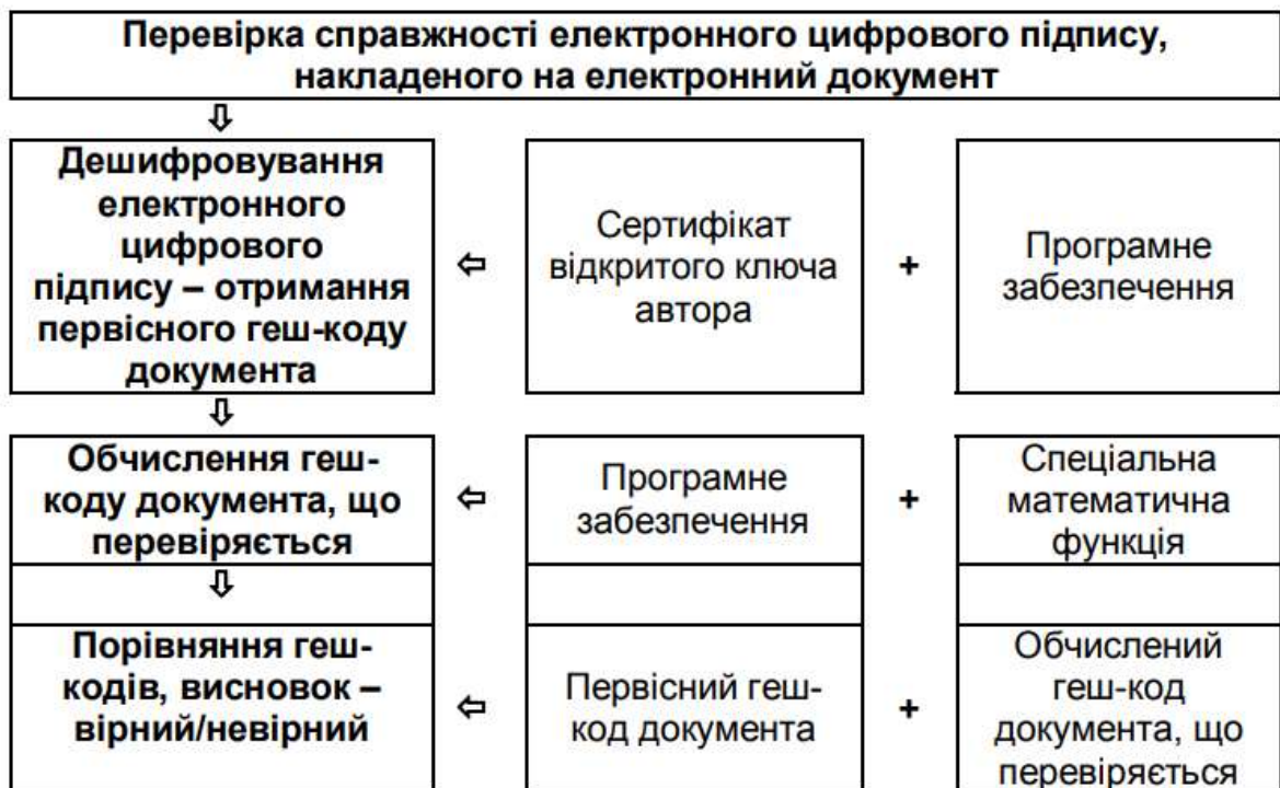
Рис. 1.5. Схема перевірки справжності ЕЦП
