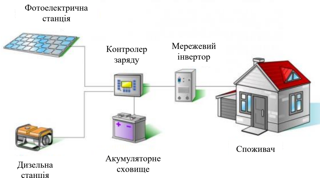
Рисунок 3.1 – Блок-схема автономно-гібридної системи електроживлення з фотоелектричним джерелом
