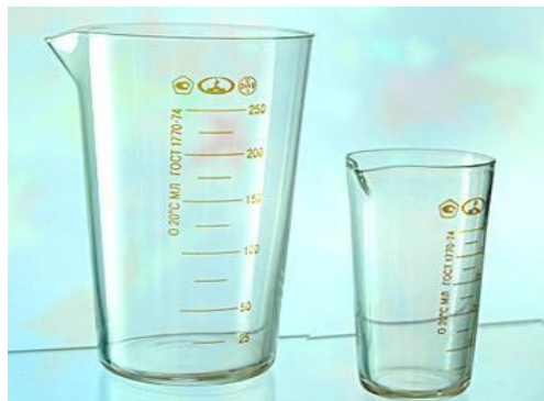
Рисунок 3.8 - Мензурки 2-класу точності по ГОСТ 1770-74
