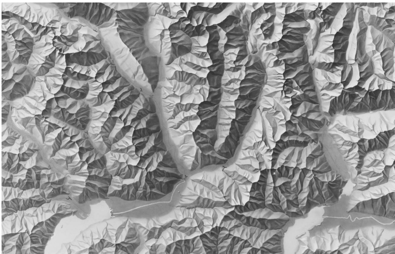
Рис. 1.2.14. Фрагмент карти кантону Граубюндена з оформленням рельєфу способом світлотіньового зображення при косому північно-західному освітленні.
