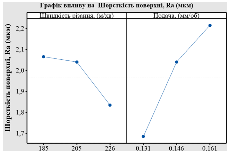
Рисунок 6.3 – Вплив режимів різання на шорсткість поверхні
