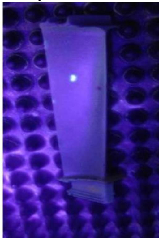
Рис. 6. Капілярний (люмінісцентний) метод контролю [2]
