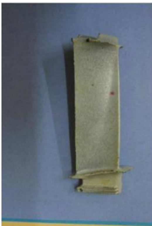
Рис. 6. Капілярний (люмінісцентний) метод контролю [2]
