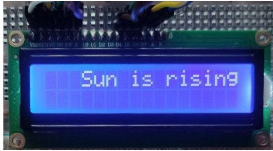
Рисунок Д.15 – Тестування функції виставлення курсора на апаратному обладнанні.
