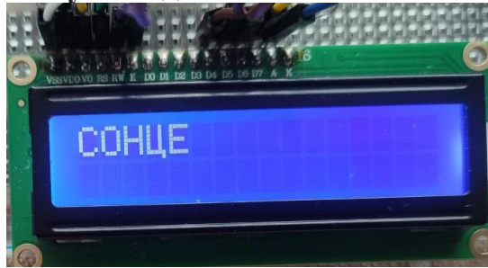
Рисунок Д.21 – Тестування функції виводу рядку кирилиці разом із символами латиниці на апаратному обладнанні.
