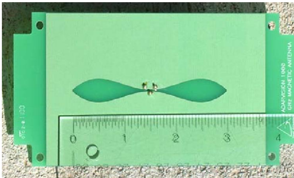
Рисунок 10 - Надширокосмугова магнітна щілинна антена Барнса [16]
