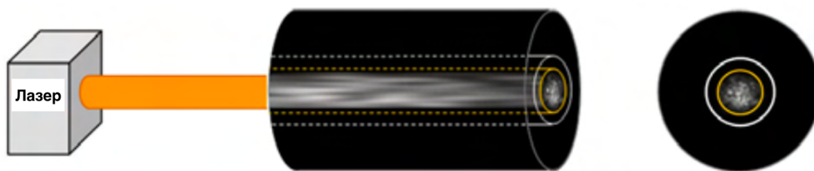
Рис. 1.21. Передача світла в багатомодовому волокні в умовах неповного заповнення.
