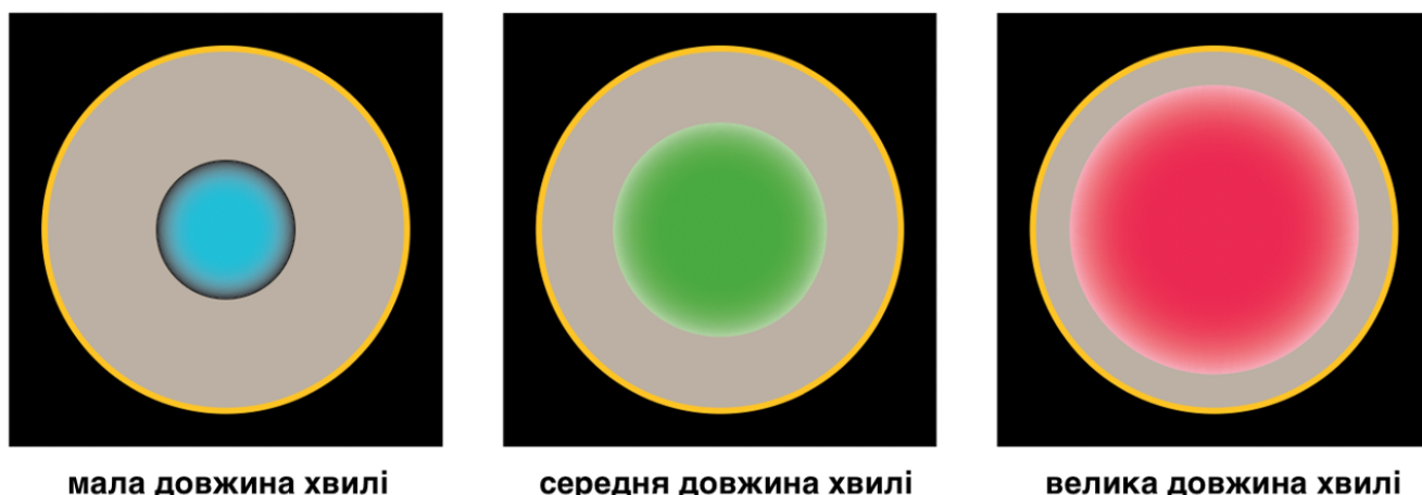
Рис. 2.8. Зміна MFD в залежності від довжини хвилі.
