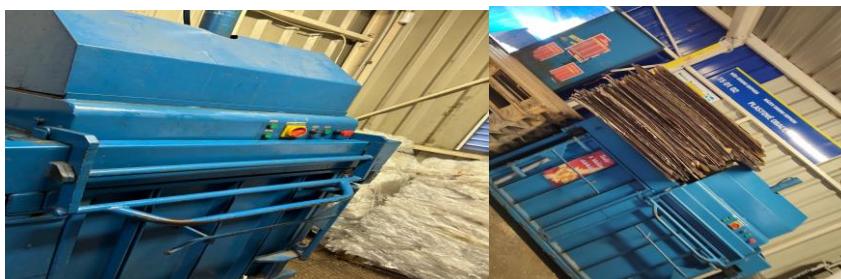
Рис. 3.5 Преси для зменшення об'єму пластику та картону
