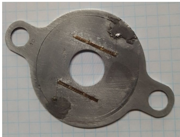
Рисунок 14 - Колектор з сіткою AlSi (1%) діаметром 25 мкм, кроком 1 мм
