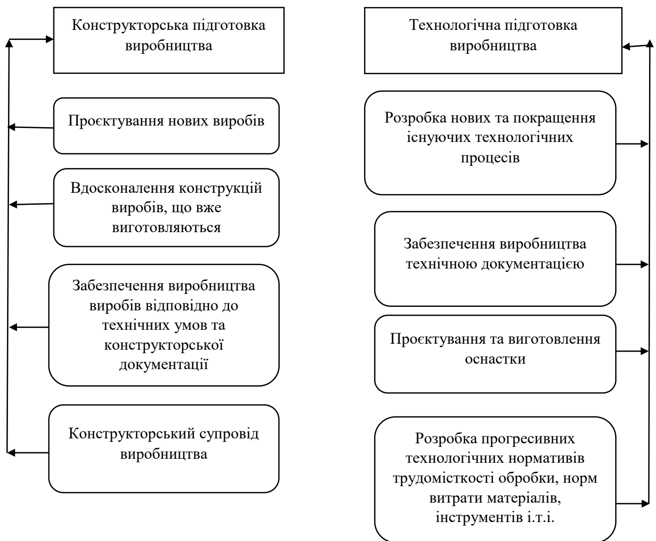
Рисунок 1.2 – Основні заходи, що реалізуються в ході конструкторської та технологічної підготовки.
