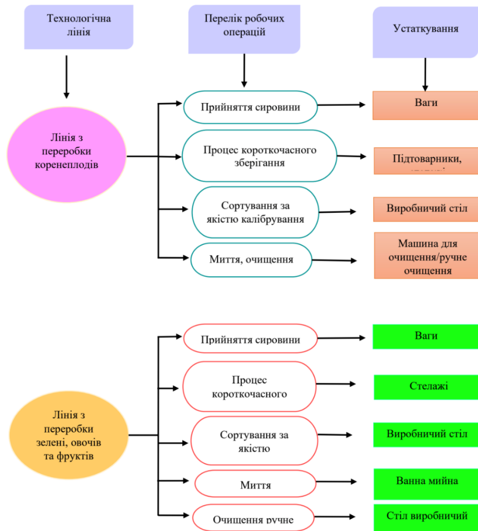
Рис. 2.9. Виробничий процес заготівельного цеху (овочевий цех)
