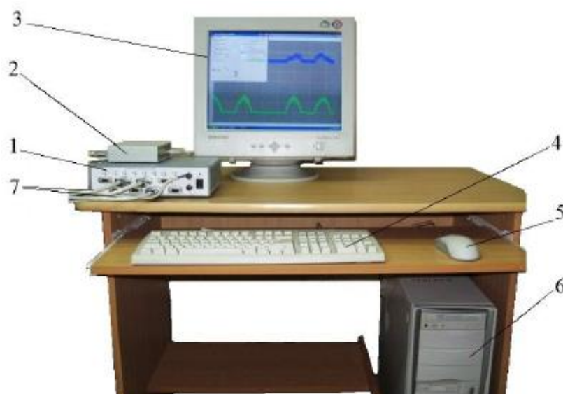
Мал. 5.2. Автоматизоване робоче місце для вимірювання складових сил шліфування: 1 – восьмиканальний вимірювальний підсилювач; 2 – аналого-
