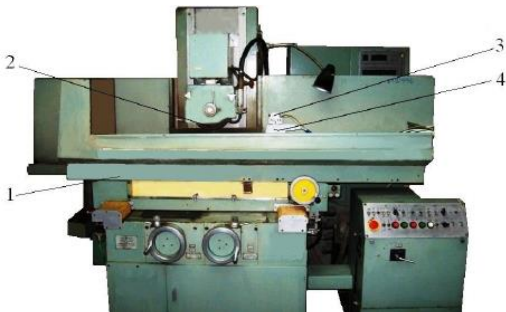
Мал. 5.1. Загальний вигляд експериментальної установки на базі плоскошліфувального верстата мод. 3Е711ВФ2: 1 – плоскошліфувальний верстат мод. 3Е711ВФ2; 2 – шліфувальний круг; 3 – заготівля (напівштучна термопара); 4 – універсальний динамометр УДМ – 100
