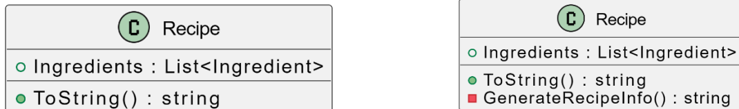
Рисунок 2.1 – Фрагменти UML-діаграм до та після прийому відокремлення методу
