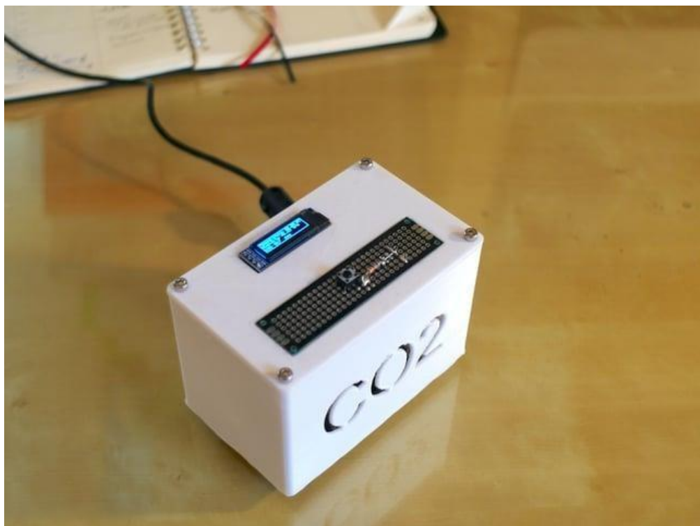
Рисунок 3.4 – Приклад надрукованого на 3D-принтері корпусу для датчика CO2
