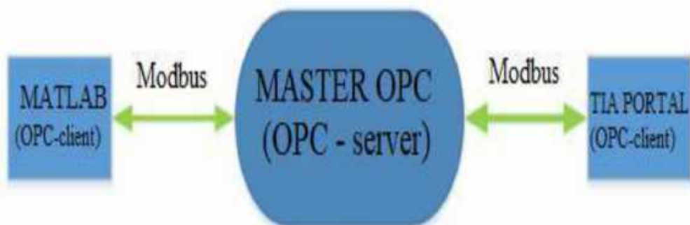
Рисунок 52 – Структурна схема зв'язку програмних комплексів з OPC
