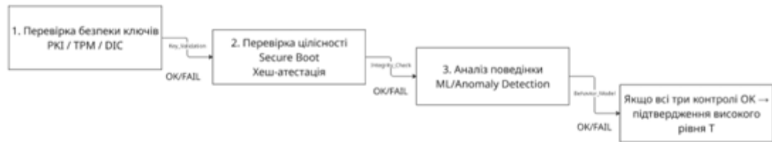
Рис.2. Логічна схема багатофакторної валідації пристрою в Zero Trust
