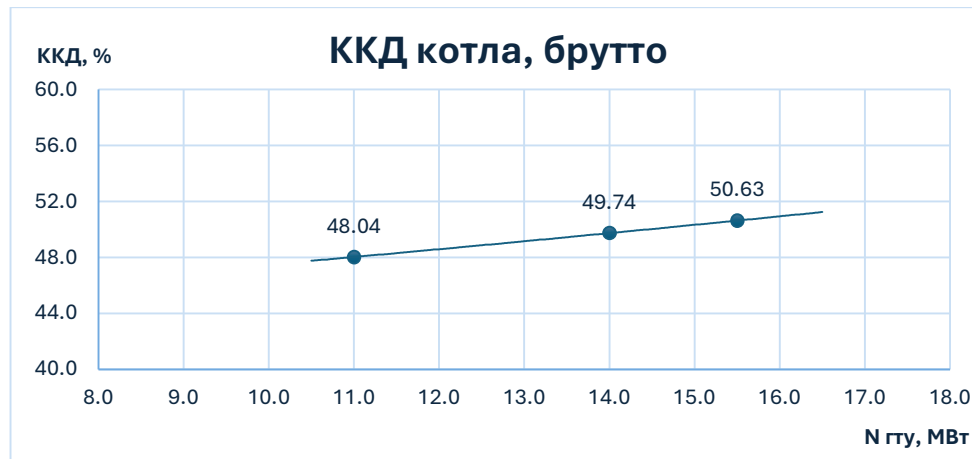
Рис.4.1.4 – Графік залежності ККД котла бруutto від навантаження ГТУ
