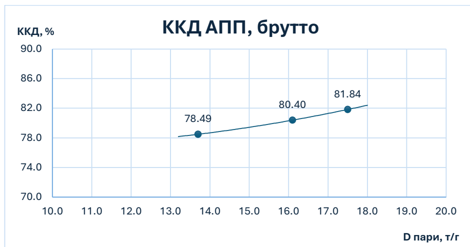
Рис.4.2.2 – Графік залежності ККД АПП бруто від паропроductивності КУ
