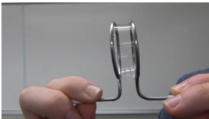
Рисунок 2.8 – Демонстраційний експеримент із мильною плівкою, натягнутою між двома кільцями
