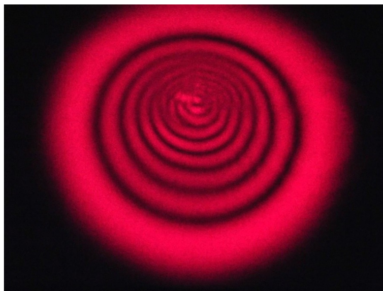
Рисунок 1.8 – Характерна «кільцева» структура поперечного розподілу інтенсивності лазерного пучка після проходження 1-мм шару поглинаючої рідини при «сильному» тепловому самодефокуванні. «Приплюснутість» картини у верхній частині картини зумовлена конвективним потоком рідини через її нагрівання лазерним світлом
