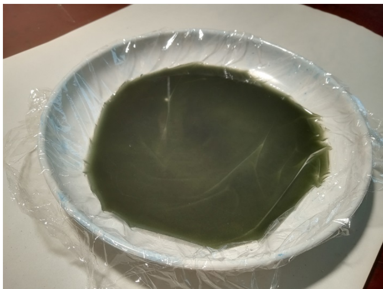
Рис.3.3. Зміна кольору водорозчинних компонентів дріжджів після \text{CO}_2 - екстракції при 50 атм. протягом 30 хвилин і сушінні при 40^\circ\text{C}
