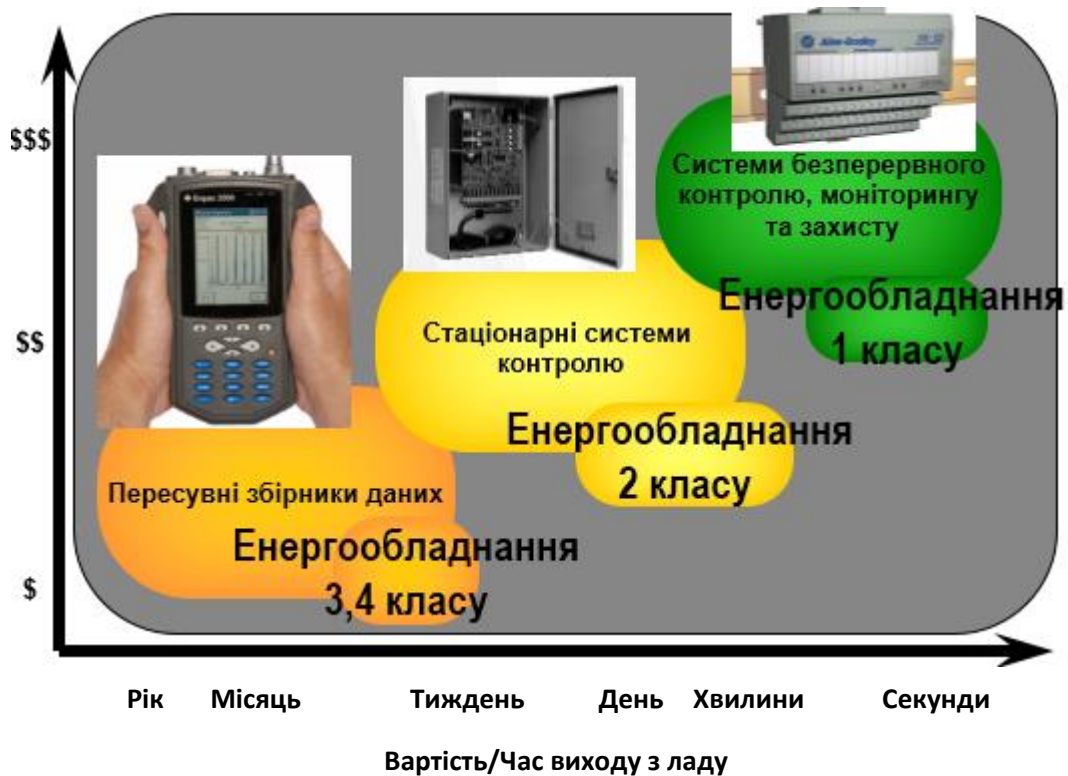
Рисунок 2.4. – Комплексний підхід до діагностики технічного стану обладнання
