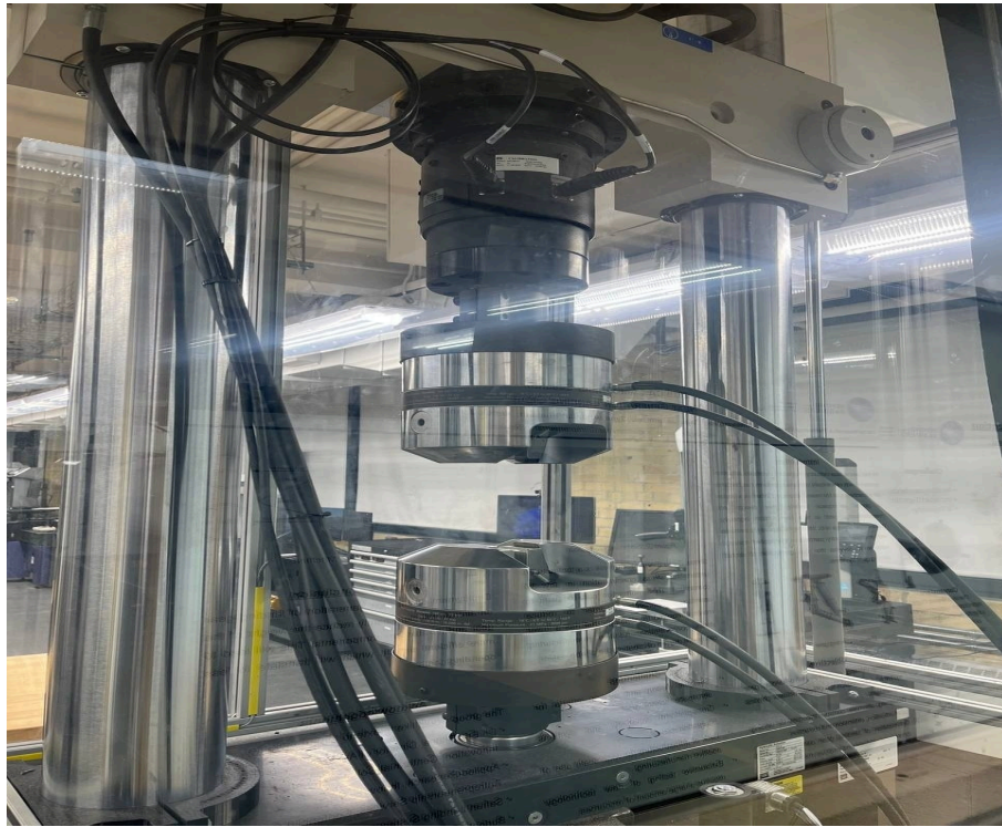
Рисунок 4. Сервогидравлічна установка для проведення механічних дослідів при кімнатних температурах у коледжі Сентенніал (Centennial College) (Торонто, Канада).
