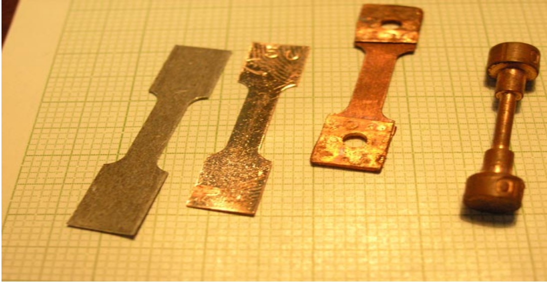
Рис. А Типи зразків, що використовуються для механічних досліджень
